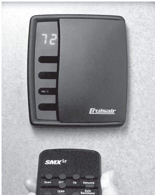
Indicadores/puerta (3/4) del teclado SMXir con mando a distancia
